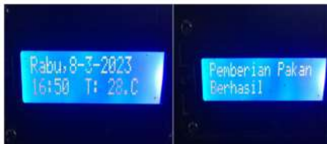
Gambar 11. Tampilan LCD Alat Monitoring dan Pemberian Pakan Ikan
